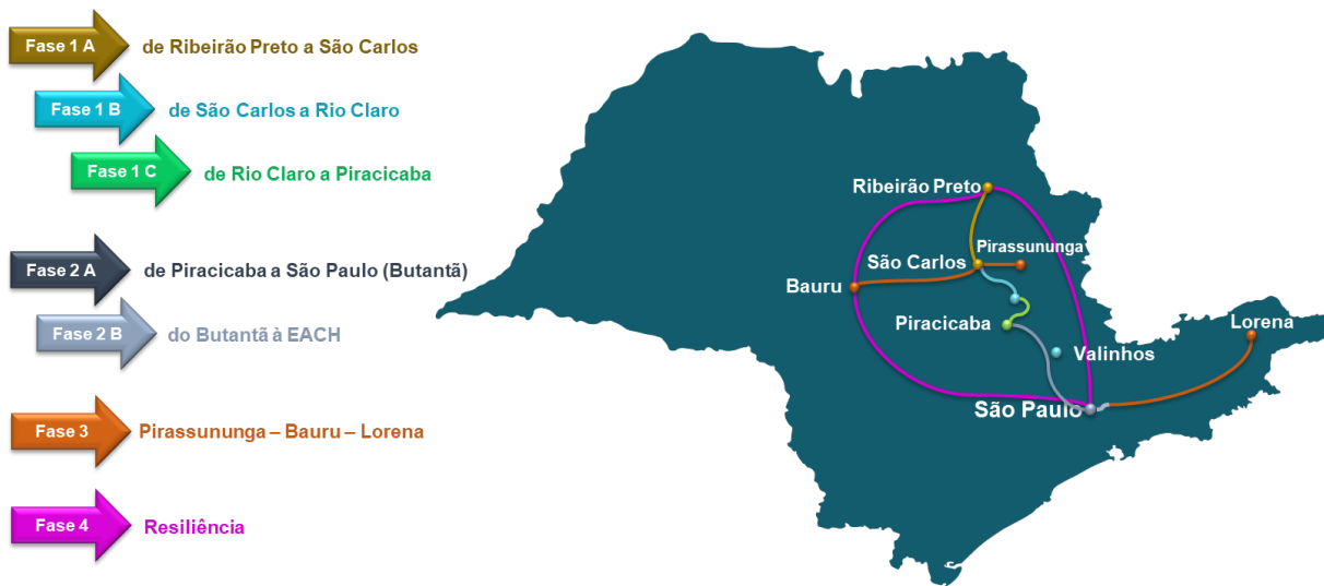
Figura 3. Projeto de Backbone com infraestrutura própria de fibra óptica entre os campi USP
