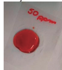
Figura 1: Microdispositivo em Papel Transparência de Retroprojetor
