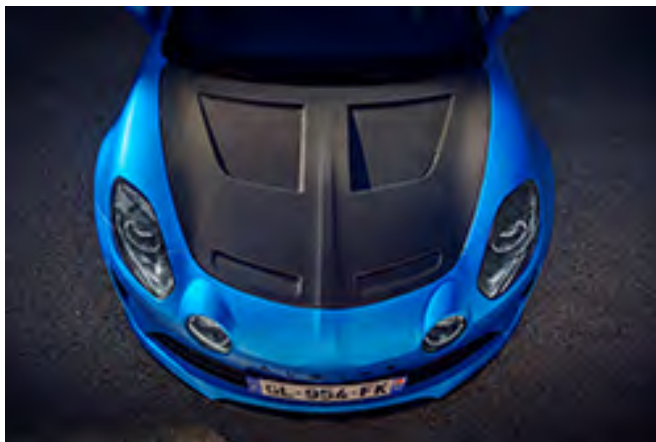
Entièrement réalisé en fibre de carbone, le capot de l'A110 R perd 2,9 kg. Les deux conduits d'air optimisent l'aérodynamisme de la sportive.
