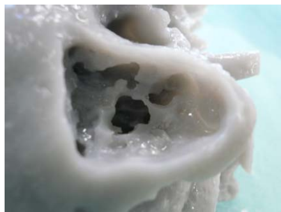
Abb. 2: Präparationsschritt Mastoidektomie mit Darstellung der mastoidalen Zellstrukturen am Modell
