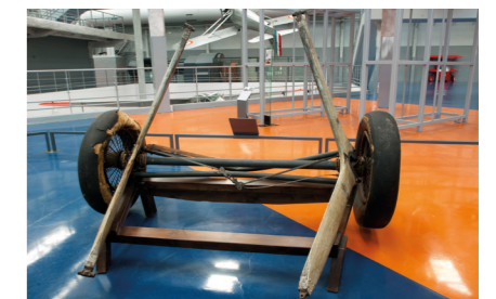
Le train d'atterrissage de l'Oiseau blanc © Musée de l'Air et de l'Espace - Paris-Le Bourget / Alexandre Fernandes
