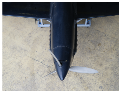
Cellule de l'avion Caudron C.714-R sans train d'atterrissage ni moteur Issy-les-Moulineaux, 1938-1939 Structure en bois de hêtre, bouleau, spruce et limbo assemblés et collés, carénage et capots en magnésium chaudronné et duralumin rivetés et vissés, peinture refaite © Musée de l'Air et de l'Espace - Paris-Le Bourget / C. Semenoff-T-C
