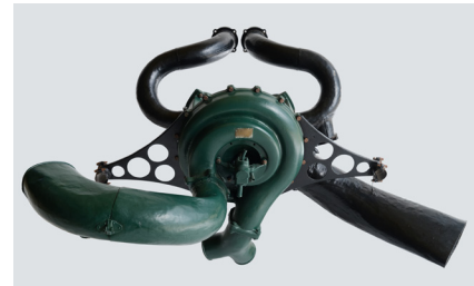
Fabricant Renault Turbocompresseur Rateau du moteur Renault type 12 FE France, vers 1918 Métal, alliage d'aluminium, métal ferreux © Musée de l'Air et de l'Espace - Paris-Le Bourget / C. Semenov-T-C
