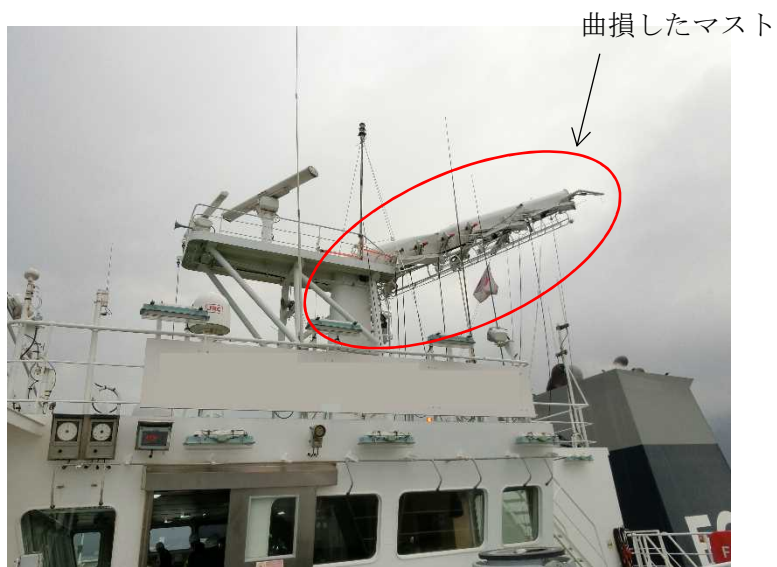
図3 本船の損傷状況
