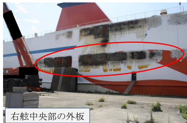
写真1 第2甲板右舷中央部の損傷状況
