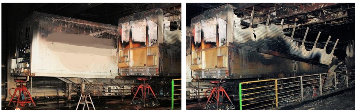
写真5 第3甲板右舷中央部に積載されていた車両の損傷状況
