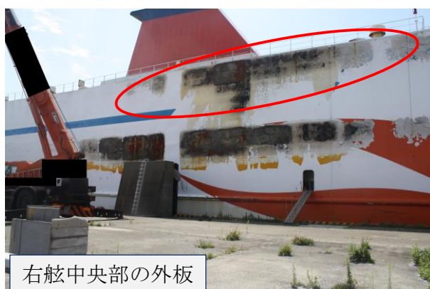
写真2 第3甲板右舷中央部の損傷状況
