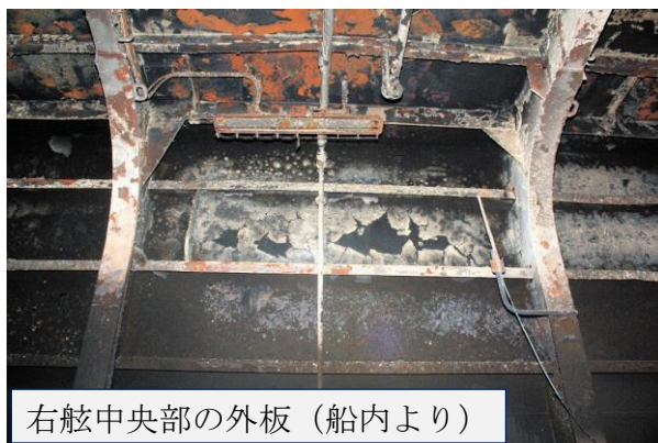
写真1 第2甲板右舷中央部の損傷状況
