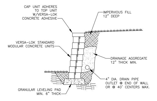
TYPICAL SECTION-UNREINFORCED RETAINING WALL
