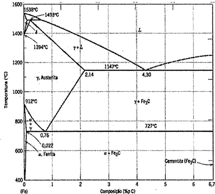
Suponha que haja uma liga contendo 0,5% em peso de carbono; utilizando o diagrama Fe-C, assinale a opção que apresenta as fases existentes nas temperaturas de (I)  $1800^\circ \text{C}$ , (II)  $1000^\circ \text{C}$ , (III)  $760^\circ \text{C}$ , (IV)  $500^\circ \text{C}$ .
