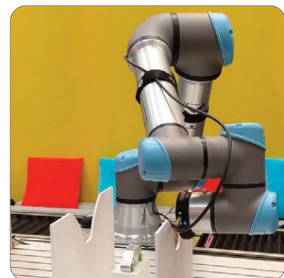
Der Demonstrator zur IIP-Plattform scannt ein Metallauto, um nach möglichen Fehlern zu suchen.
