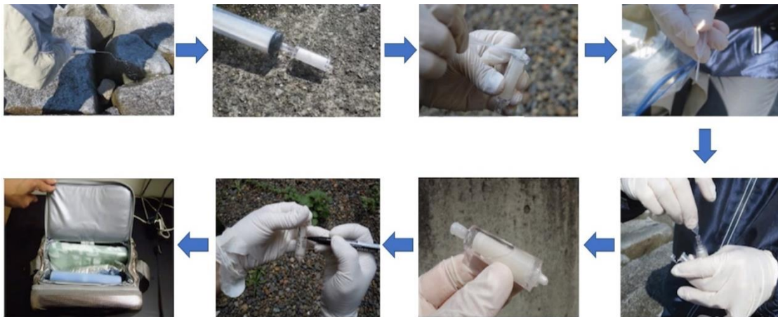
Figura 6 - Etapas para coleta de amostra com filtro Sterivex™
