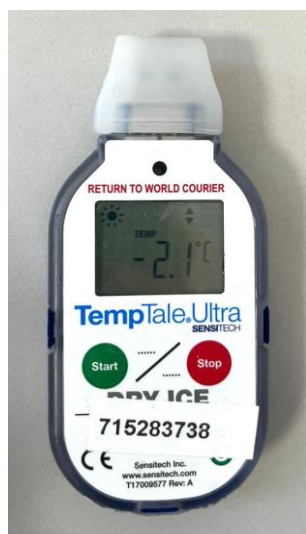
Figura 3. Foto ilustrativa de um termômetro utilizado pela transportadora e que deve estar ligado no momento de colocar as amostras na caixa com gelo seco.
