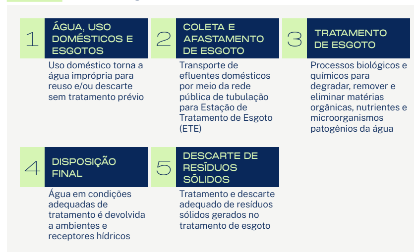
FIGURA 2 Ciclo do Esgotamento sanitário
