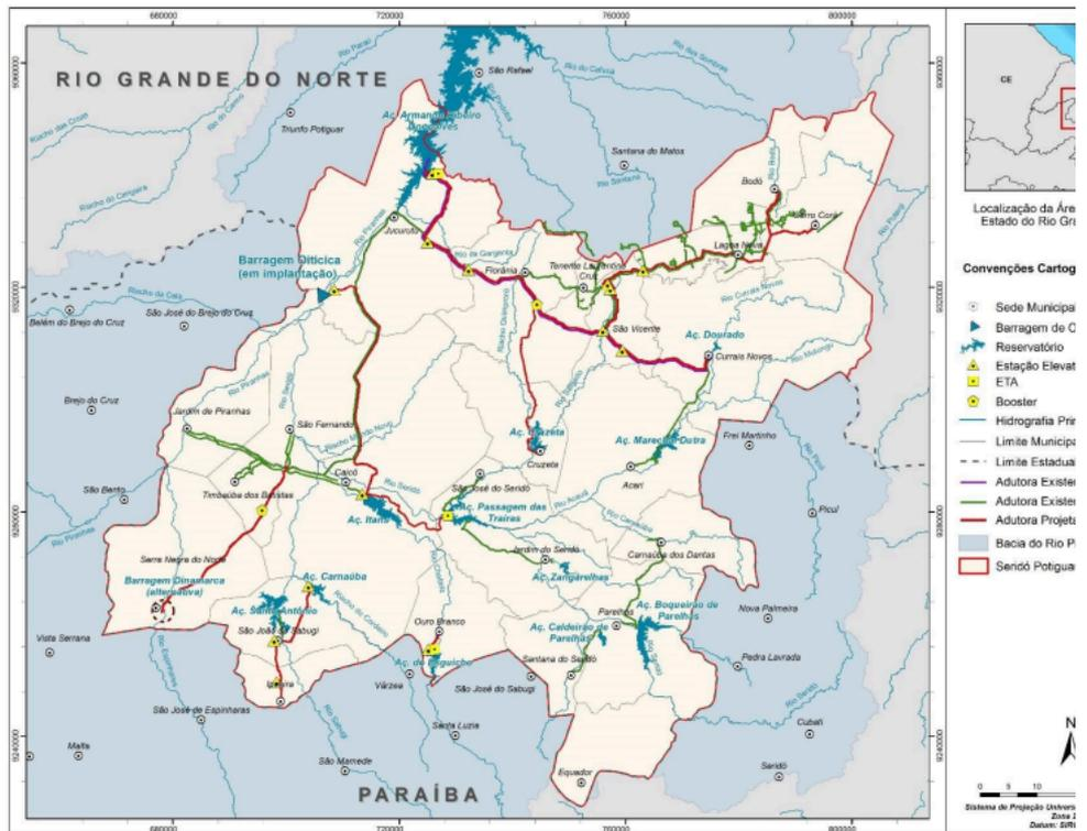
Figura 2.1 – Arranjo Geral dos Sistemas Adutores do Seridó Norte e Seridó Sul
