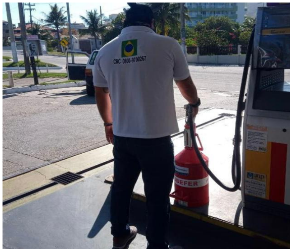
Agente de Fiscalização da ANP realiza verificação de volume em bombas medidoras
