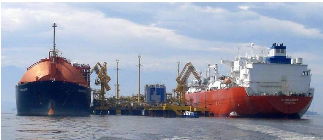
**Figura VIII.1** – Visão panorâmica do Projeto GNL da Baía de Guanabara, mostrando o navio regaseificador Golar Spirit à esquerda e o navio supridor Excellence à direita.
