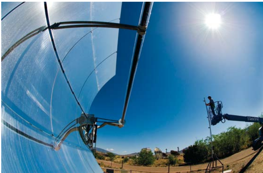
Uno specchio parabolico lineare sviluppato dal Sandia National Laboratory
