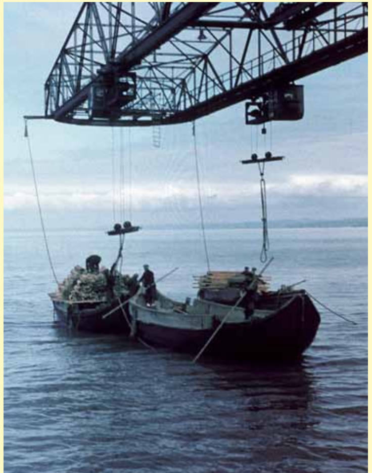
Abb. 200 Eine Ladung kurzer Balken und ein Mitfahrer werden von den Schlingen gehalten und bald in einen Leichter abgelassen.
