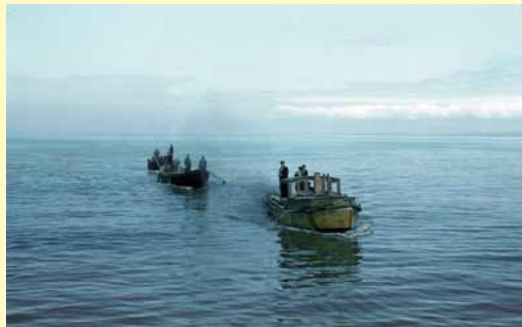
Abb. 205 Die nächsten entladenen Leichter sind eingesammelt und das Motorboot ist auf dem Rückweg zum Kran. Die Arbeiter an Bord werden zum Verstauen der Ladung benötigt, da der Ladevorgang trotz der Ladebäume der Schiffe weitestgehend in Handarbeit erfolgt.
