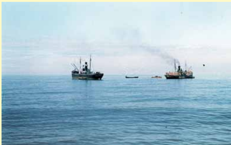
Abb. 204 Am linken Schiff ist ein noch beladener Leichter zu erkennen, rechts sind mehrere Boote längsseits am Schiff vertäut und die Umladung im vollen Gange. Im Hintergrund hat das Motorboot bereits einen entladenen Leichter eingesammelt und ist auf dem Weg zum zweiten Schiff.
