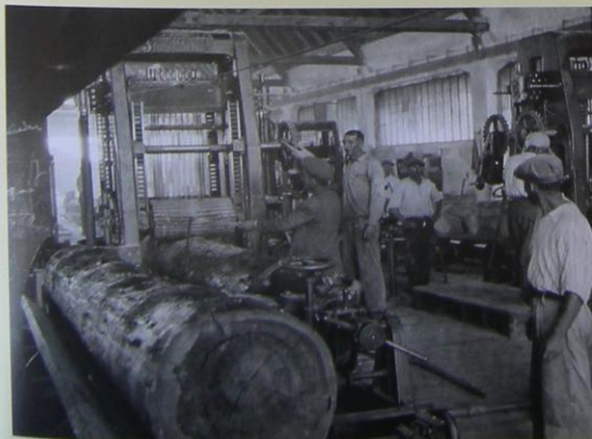
Abb. 147-149 Eine Gattersäge bei der Arbeit: nach Vermessung des Blochs werden die Sägeblätter zur Optimierung des Verschnitts entsprechend eingestellt, danach wird der Baumstamm durch die Säge gefahren. Die geschnittenen Balken und Bretter werden mit Rollentransporteur zur Weiterverarbeitung transportiert.
