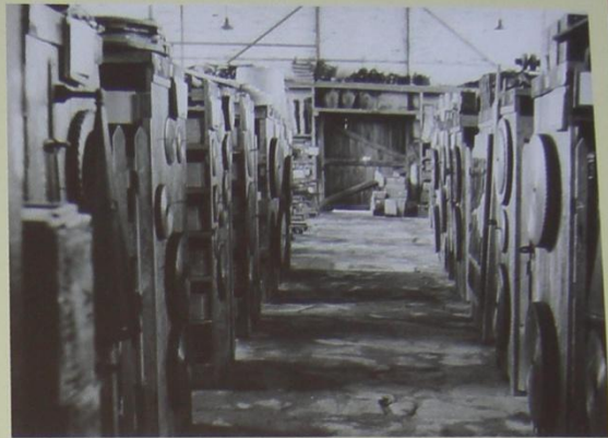
Abb. 161 In der Kistenfabrik sind lange Reihen automatischer Schneid-, Hobel- und Fügemaschinen aufgestellt.
