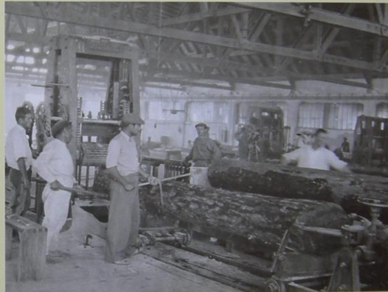
Abb. 146 Übersicht über die Sägehalle 14 mit den Gattersägen von 950 mm, 800 mm und 650 mm Arbeitsbreite.
