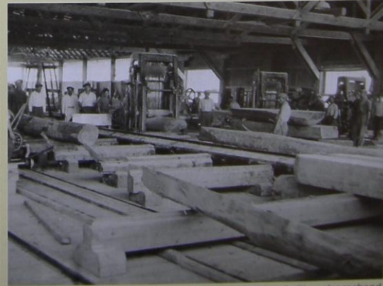
Abb. 147-149 Eine Gattersäge bei der Arbeit: nach Vermessung des Blochs werden die Sägeblätter zur Optimierung des Verschnitts entsprechend eingestellt, danach wird der Baumstamm durch die Säge gefahren. Die geschnittenen Balken und Bretter werden mit Rollentransporteur zur Weiterverarbeitung transportiert.
