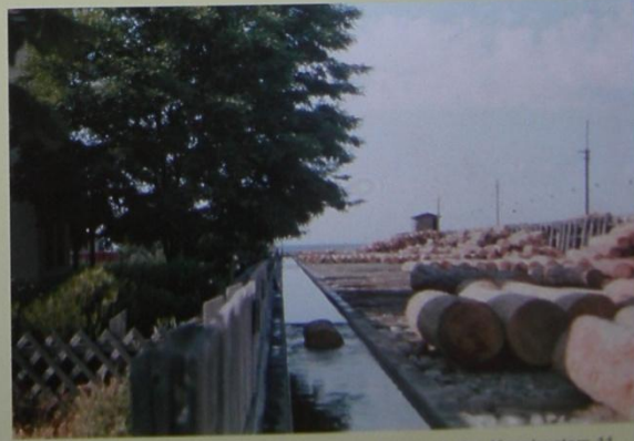
Abb. 142 Zur Weiterverarbeitung werden die Blöcke in das Kanalsystem 11 gerollt und mit dem Wasserstrom zum Klotzteich 12 transportiert. Links hinter dem Jägerzaun liegt das Verwaltungsgebäude.
