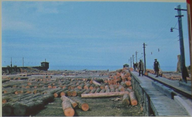
Abb. 139 Die Kettentransporture 6 bringen die auf Länge geschnittenen Blöcke zum richtigen Lagerplatz 7. Der Abwurf erfolgt von Hand mit Hilfe von Kanthaken.
