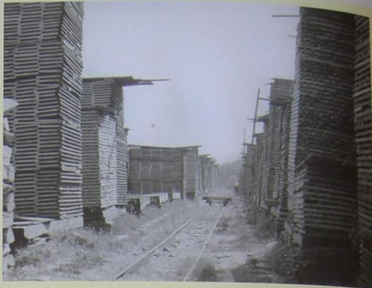
Abb. 156 Auf dem Holzlagerplatz 17 wird die Schnittware gestapelt und luftgetrocknet.
