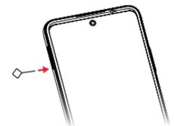
2. Coloque o retire la tarjeta Nano SIM y la tarjeta microSD™ con los contactos metálicos bocabajo en la bandeja. Deslice suavemente la bandeja de la SIM en la ranura.
