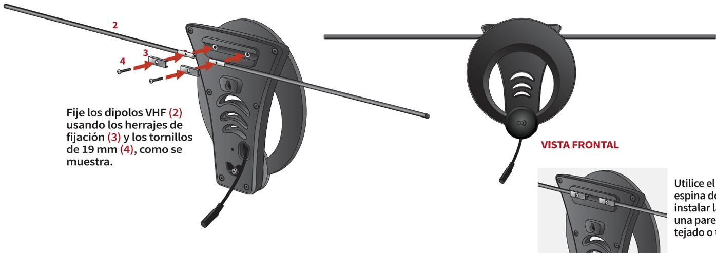
Fije los dipolos VHF (2) usando los herrajes de fijación (3) y los tornillos de 19 mm (4), como se muestra.
