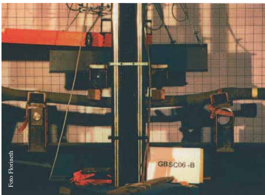
Fig. 12.1.1 Macchina per misurare l'elasticità delle piante presso l'Università di Vienna
