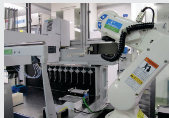
Sistema robotizado para varredura de fármacos em larga escala e análises celulares multiparamétricas.
