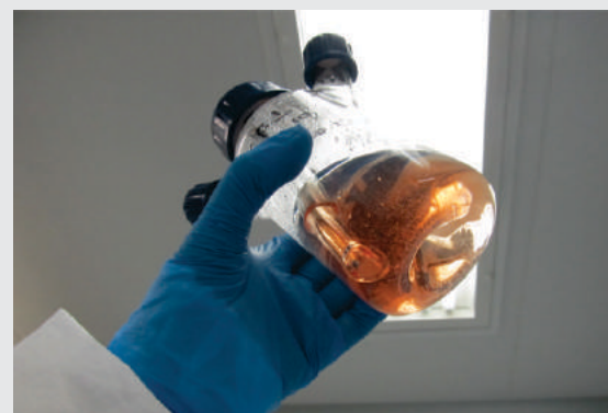
Frasco "Spinner" utilizado para cultivo de células neurais em três dimensões, neste caso, organoides cerebrais.
