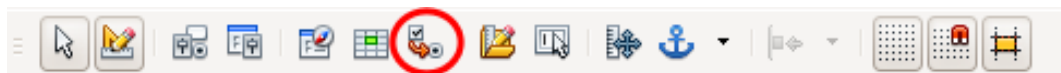
Figura 237: barra degli strumenti Struttura del formulario con l'icona Sequenza di attivazione cerchiata
