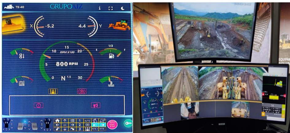
Figura 21. Monitor do Cockpit de Operação mostrando os principais parâmetros de operação e manutenção.
