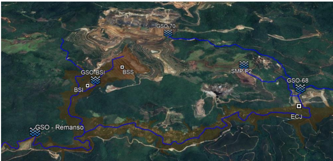
Figura 28. Mapa da rede de monitoramento do parâmetro turbidez para a obra de descaracterização da barragem Sul Superior. Fonte: Vale, 2024.
