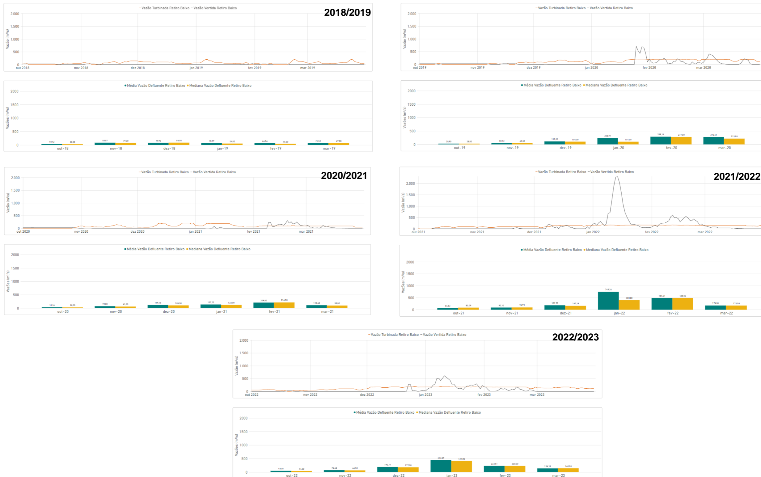
Gráfico 4.2-10 Operação da UHE Retiro Baixo nos períodos de chuva tendo em vista as vazões vertidas, turbinadas e defluentes
