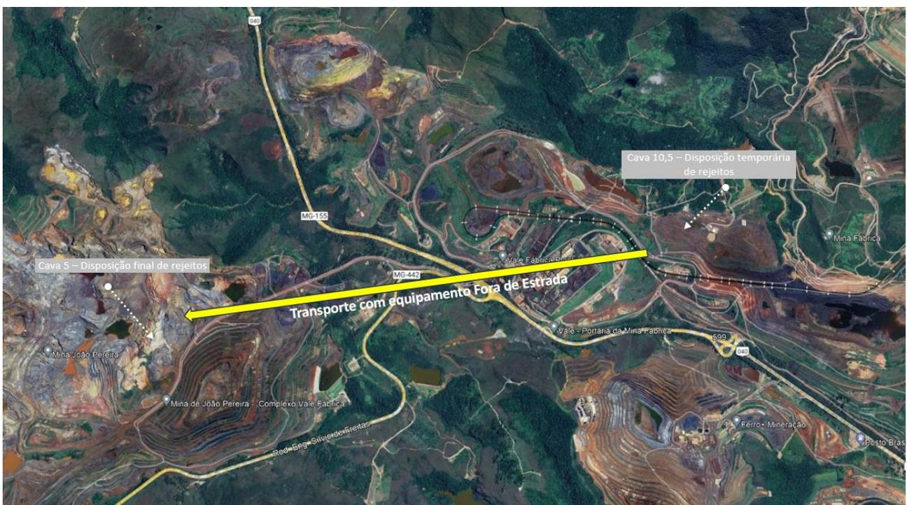
**Figura 8:** Transporte de rejeito com fora de estrada da Cava 10,5 para Cava 5
