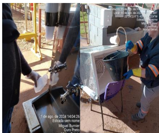
Figura 109 - Coleta de água para Análise de potabilidade no bebedouro no Canteiro Forquilha. Fonte: Vale, agosto 2024.
