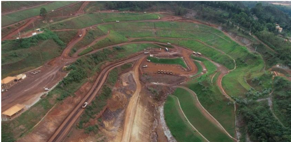
Figura 22 - Vista da PDE-X após processo de revegetação bem estabelecido. (Fonte: Vale, 11 de abril de 2024).
