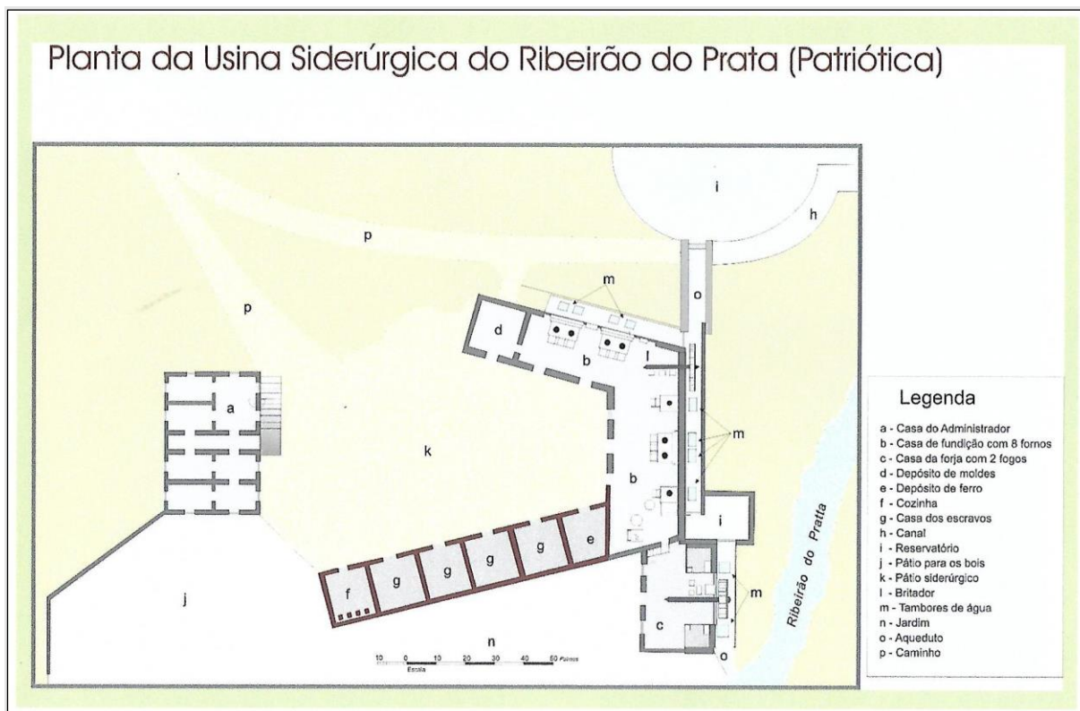
Figura 77: Planta da Fábrica Patriótica com suas diferentes partes identificadas.
