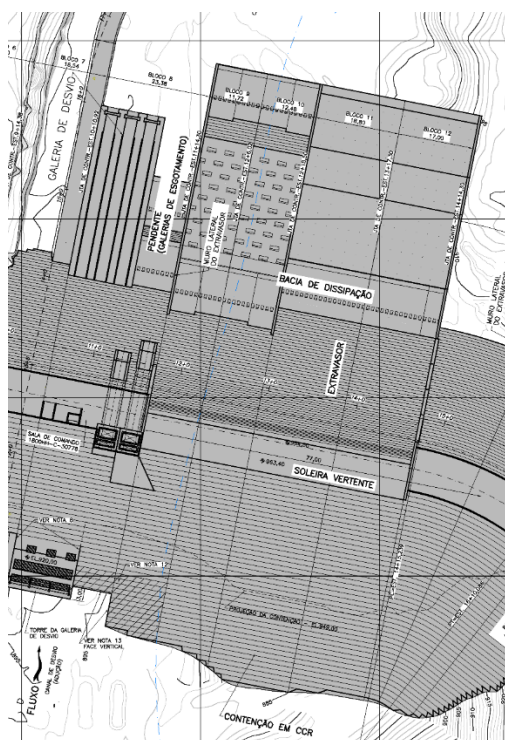
Figura 4.8 – Desenho em planta com detalhe do reforço dos blocos 9 e 10, a jusante (Fonte: NP-1850HH-C-00001 Rev.6).
