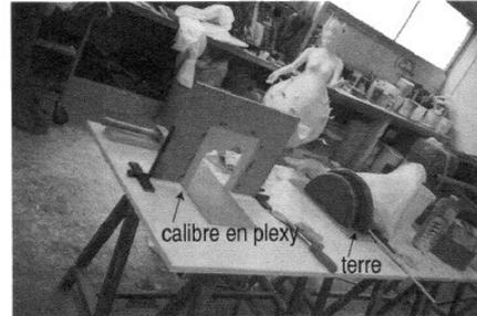
Fig. 4.28 : Modèle traîné en terre
