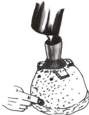
Fig. 5.93 : Coulage de l'élastomère à l'intérieur de la chape
