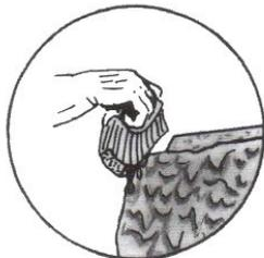
Fig. 6.8 : Renforcement des angles
