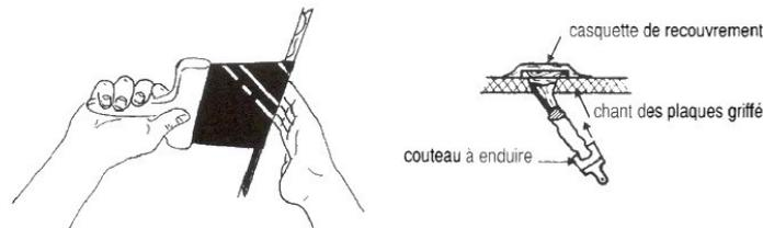
Fig. 7.20a : Bourrage des joints et des noirs
