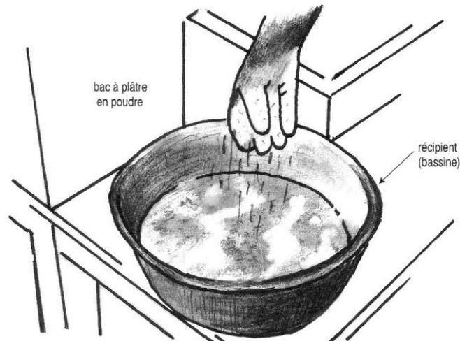
Fig. 3.1 : Mélange de la poudre de plâtre à mouler battu avec la main
