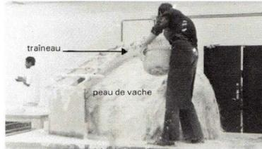
Fig. 4.68 : Réalisation de la peau de vache
