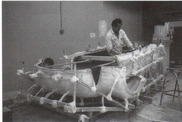
Fig. 6.61 : La pâte est armée d'un tissu de verre imprégné de résine époxy
