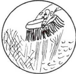
Fig. 6.10 : Projection sur la filasse d'une deuxième couche de plâtre
