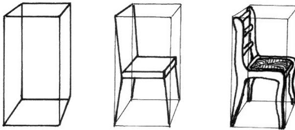
Fig. 2.36v : Technique permettant de dessiner rapidement un volume
