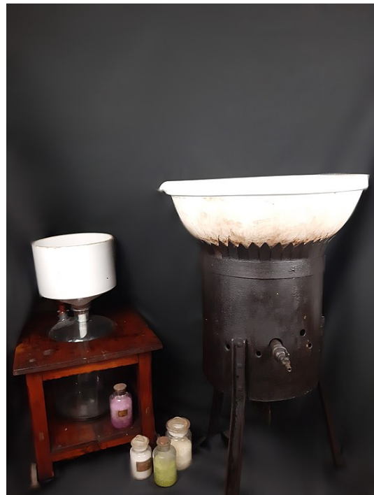
Fig. 3.1: Attrezzatura per la cristallizzazione frazionata utilizzata per separare le terre rare
