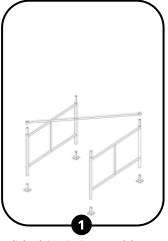
Alinhe dois painéis em paralelo. Na parte superior, encaixe a trava entre as extremidades invertidas. Na parte inferior, encaixe a base (rodas, sapatas fixas ou reguláveis).
