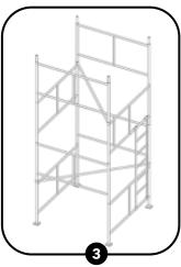
A cada três metros de altura colocar uma diagonal, sempre no sentido contrário à anterior. Encaixe a
