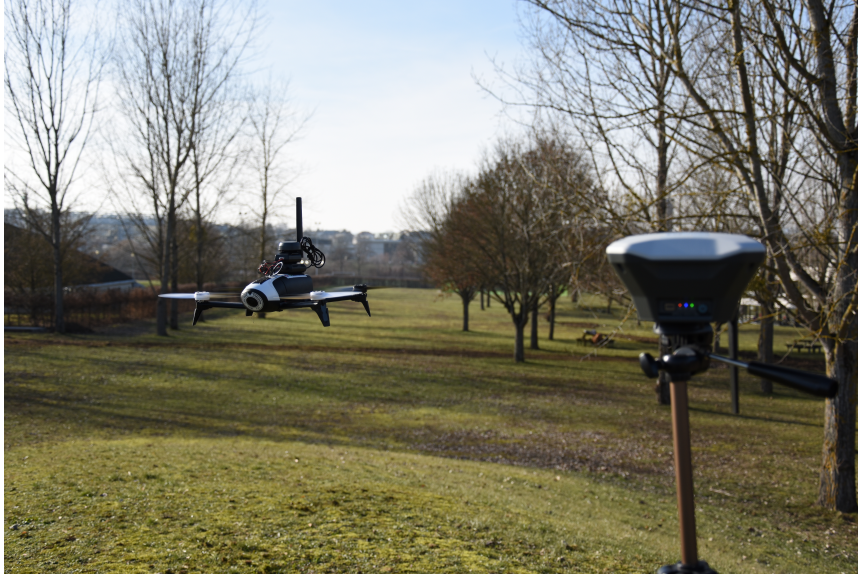
FIGURE 4.7 – Le drone Parrot utilisé, équipé du gps RTK.
