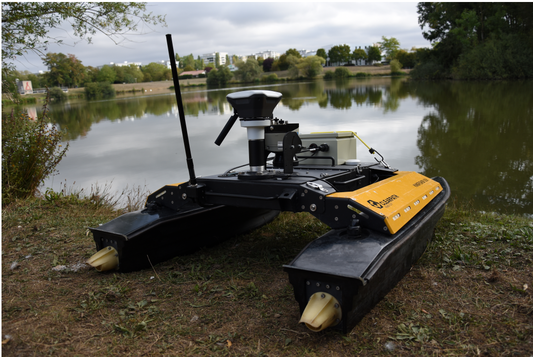
FIGURE 4.10 – Bateau Héron de clearpath utilisé dans les expériences
