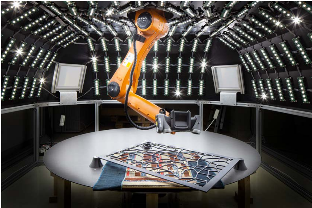
FIGURE 5.3 – Photographie de l'intérieur de l'expérience. On peut voir le dôme couvert de LED, le robot, le scanner et sa mire, la table support, et un objet à numériser.
