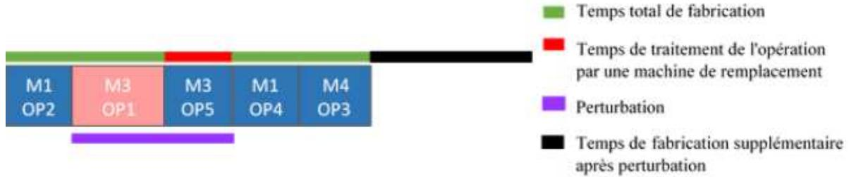
Figure 4-7 Extension 1 : perturbations sans machine de remplacement
