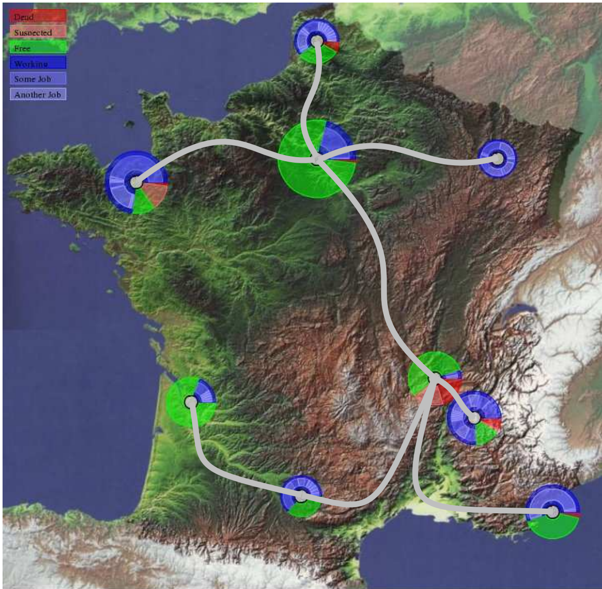
FIG. 3.3 – Carte des sites de la grille expérimentale GRID'5000 vue par l'outil de visualisation des ressources développé par Thomas Héroult (LRI/Orsay). Les sites sont reliés par un réseau 10 Gb/s reposant sur l'infrastructure RENATER.
