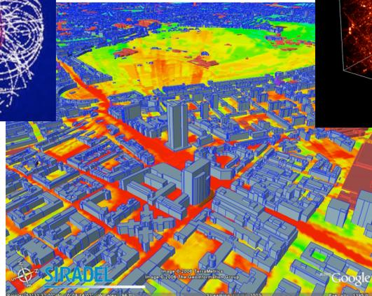
Propagation des ondes radio UMTS (SIRADEL)
