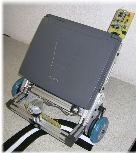
FIG. 4.24 – Le robot ER1, le capteur infrarouge et le coordinateur (module ZigBee ICARE)
