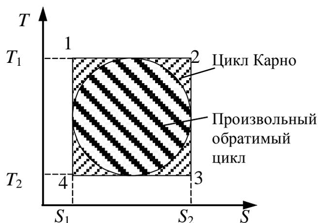
Рис. 9.3. К определению коэффициента заполнения цикла
