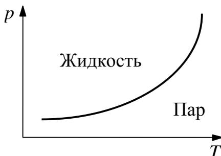
Рис. 7.6. Диаграмма состояний двухфазной однокомпонентной системы
