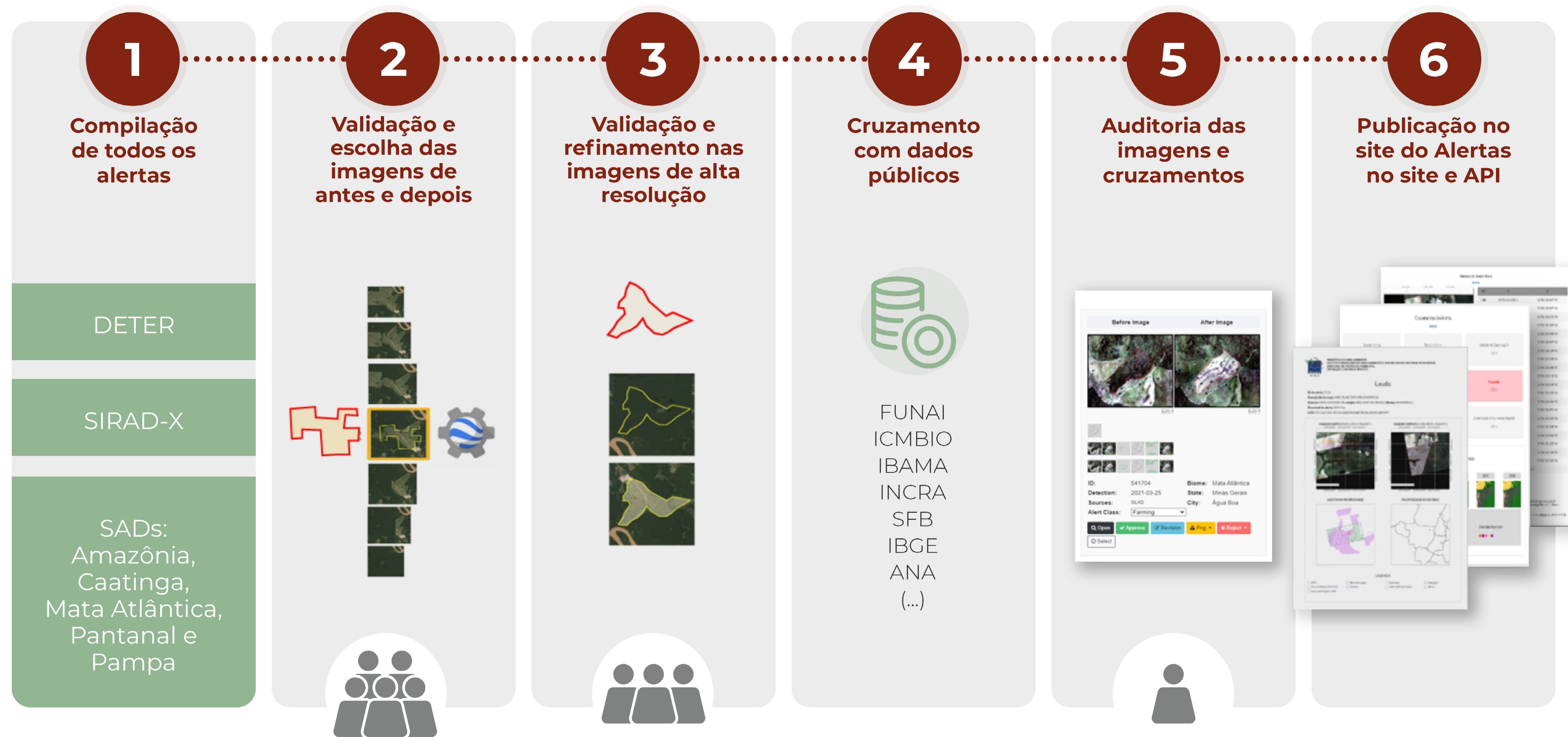
Figura 1 A | Processo metodológico do MapBiomias Alerta para compilação, validação, refinamento, cruzamento de dados, auditoria e publicação de alertas de desmatamento no Brasil..
