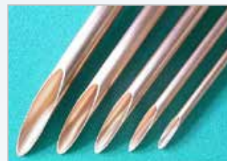
新冷媒対応内面溝付管 (左から 9.52、8.00、 7.00、5.00、4.00 mm)
