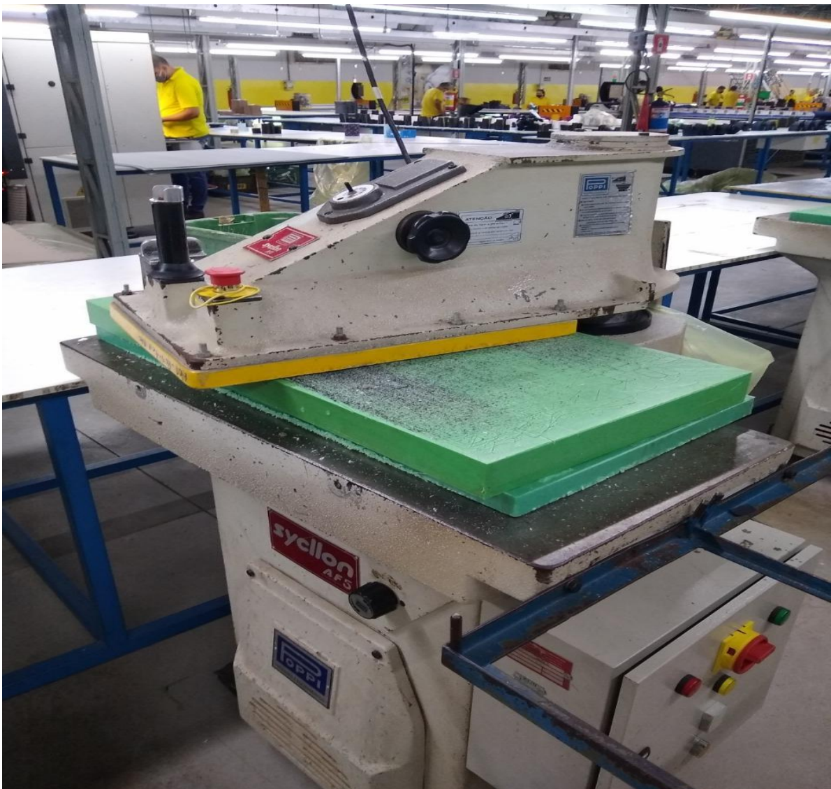
Foto 02 – Balancim (Prensa Hidráulica) para corte de calçados.
