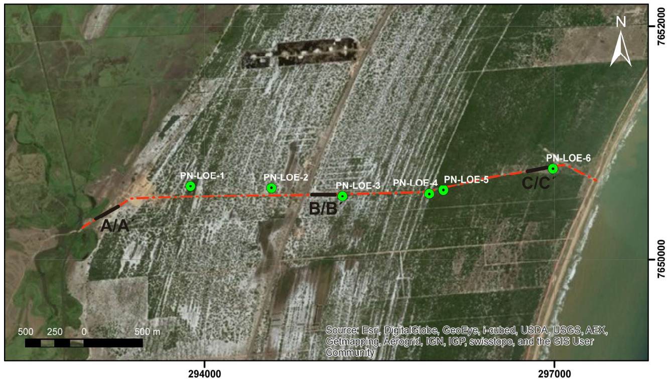
Figura 2 - Mapa com a localização dos métodos aplicados em campo na área de estudo. A linha vermelha tracejada representa o levantamento topográfico e o levantamento total feito com o GPR (4,2 km). As linhas em preto representam as seções de GPR que caracterizam os padrões de empilhamentos definidos. Os círculos em verde indicam o posicionamento das amostragens de LOE.
