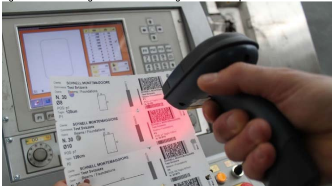
Figura 7 - Interface digital via leitor de código de barra acoplado no terminal CAM
