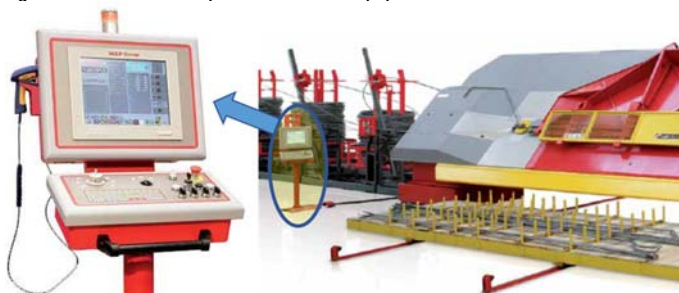
Figura 6 - Terminal CAM para controle de equipamento de corte e dobra
