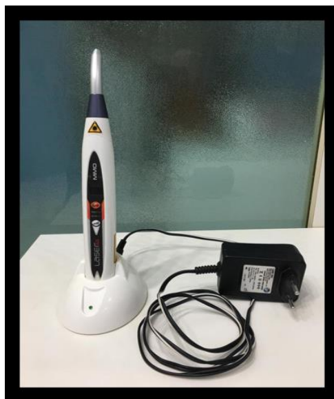
Figura 1. Laser em caneta com a ponteira convencional, encaixada no suporte onde carrega sua bateria quando for necessário e quando a fonte de alimentação estiver plugada na tomada elétrica (Laser Duo, MMO, São Carlos, SP, Brasil) (Arquivo pessoal dos autores).
