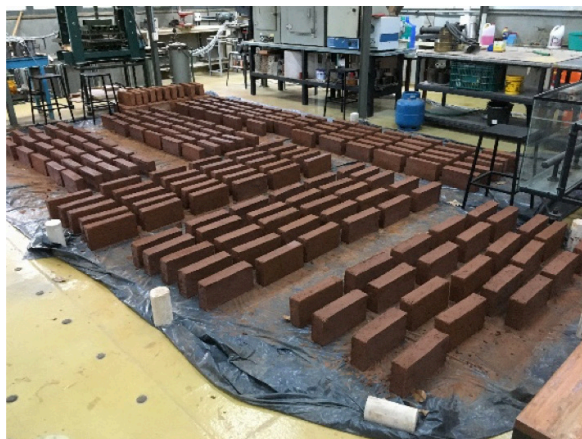
Figura 1 (topo): Produção semi-mecanizada de adobe em larga escala no Novo México, EUA. Fonte: Foto do autor, 2019.
