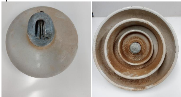
Fig. 6. Isolador nº 24 da cadeia de isoladores contaminado naturalmente – vista superior e inferior
