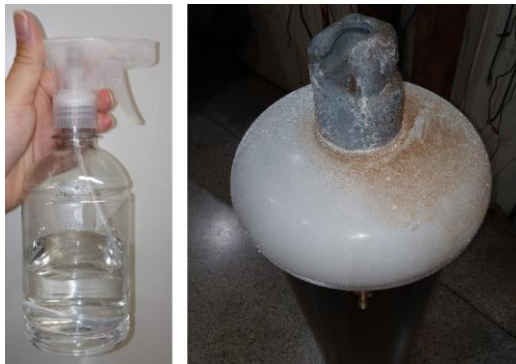
Fig. 7. Borrifador utilizado no experimento e superfície do isolador 24 umidificada
